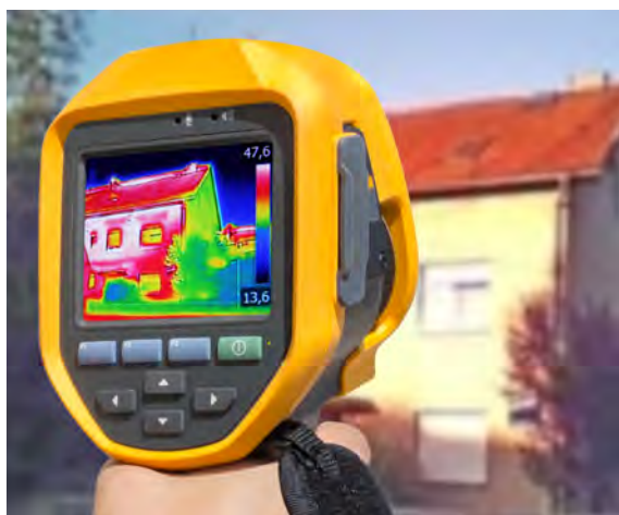
Réalisation d'une thermographie
