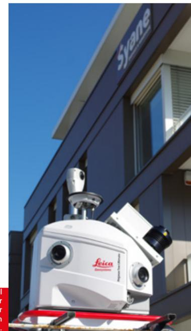
Appareil Lidar Mobile géolocalisé en temps réel et embarqué sur un véhicule. Deux têtes laser captent 1 million de points à la seconde pour générer un nuage de points, offrant une vision en 3 dimensions de l'environnement.
